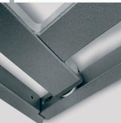
La continuità delle forme e la particolarità tecnica dello snodo (**brevetto AEK**) ricavato all'interno del tubolare 30 x 40, rende **forte ed elegante** l'inferriata. Lo snodo può piegare di 0-90-180° e la sua **forma arrotondata** evita punti di impigliamento per vestiti e dita.
