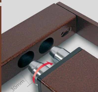
La rotazione delle ante avviene per mezzo di perno rotante di acciaio da **18 mm** che si estrae dall'anta con l'azione di una vite (**brevetto AEK**). Il perno si impegna nel telaio predisposto con **boccola teflonata** che non necessita di lubrificazione e il movimento risulta **particolarmente silenzioso**.
