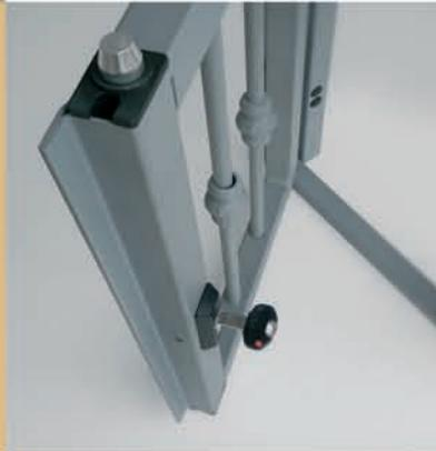
La chiusura avviene per mezzo di due perni, uno superiore e l'altro inferiore, da **18 mm** comandati dalla serratura con corsa 22-24 mm.
