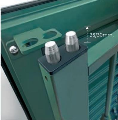
La chiusura combinata di grata e persiana avviene per mezzo di perni, due superiori e due inferiori, da **18 mm** comandati dalla serratura con corsa 28-30 mm.
