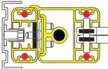
**4** Il Rinvio della serratura, sia sul lato superiore che inferiore, è realizzato con un tondino in acciaio da 8 mm.
