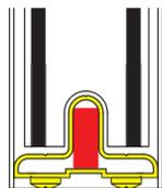
**A** Possibilità di liberare completamente il passaggio a terra con guida alzabile, con fermi magnetici e meccanici, o con guida asportabile.
