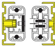
**7** Serratura con frontale in acciaio inox a 3/5 punti di chiusura e funzione blocca-pacco ad inferriata raccolta. Cilindro di Sicurezza K2.
