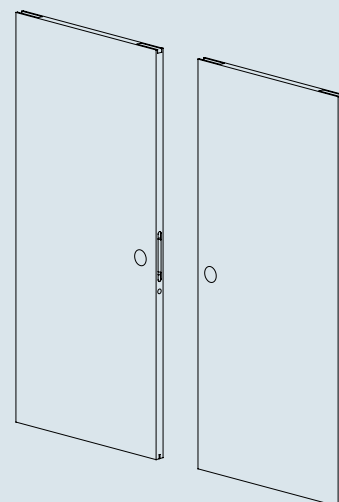
Anta con Maniglia ricavata con incasso Door panel with integrated handle
