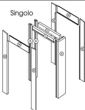
Stipite realizzato principalmente in MDF nobilitato in superficie con decorativo melaminico, completi di spazzolino parapolvere e guarnizione. Lo stipite dovrà sempre essere adeguato alla luce di passaggio durante l'installazione, mediante semplici tagli. Per le misure in pronta consegna i traversi sono sempre forniti per luce 900 e i coprifili hanno un lato maggiorato (n°3 coprifili con aletta da 30 mm). Ambedue i traversi sono predisposti per il fissaggio con viti tappi in tinta.
