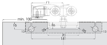
Schema di foratura vetro - Glass drilling diagram
