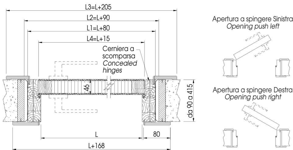
MDF ABETE GIUNTATO JOINTED FIR STRUTTURA ALVEOLARE A NIDO D'APE HONEYCOMB HOLLOW-CORE STRUCTURE
