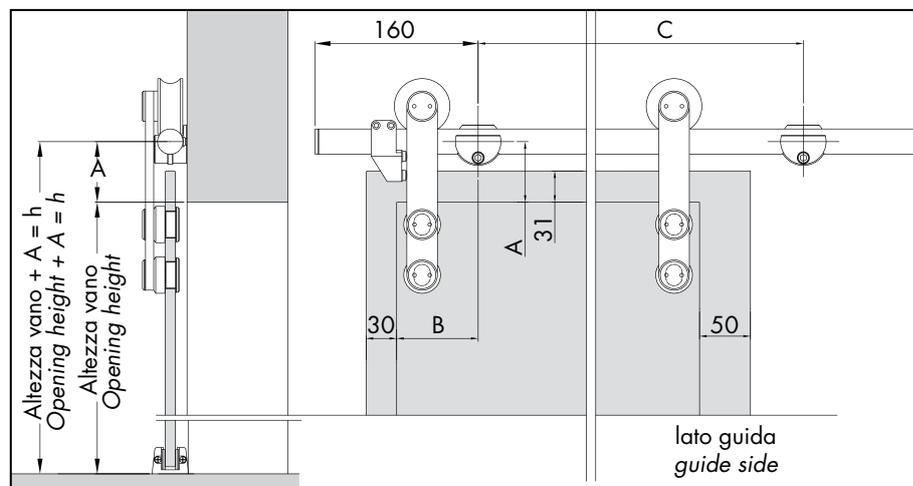
Lo schema raffigura il montaggio della barra per ANTA UNICA a parete.
