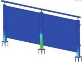
Calcolo statico ad elementi finiti (FEM) sulle tipologie di ringhiera / balaustra e varianti
