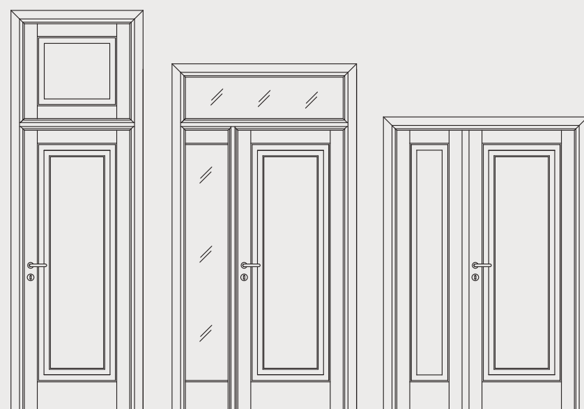
Sopraluce con battente Transom with doorleaf
