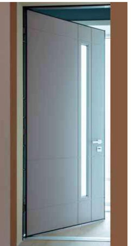
SULLE PORTE BLINDATE A VETRO ALIAS NON SONO PRESENTI CORNICI FERMA VETRO MA VENGONO PANTOGRAFATI I PANNELLI DI RIVESTIMENTO INTERNI ED ESTERNI IN MODO DA DETERMINARE LA SAGOMA DELLA FINESTRATURA. FRA IL VETRO E IL PANNELLO È PRESENTE UNA GUARNIZIONE ISOLANTE.
